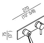
**Parte esterna per comando termostatico ad incasso con regolazione di flusso a due uscite**
