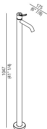
**Parte esterna per miscelatore monoforo per lavabo, predisposto per fissaggio a pavimento**
