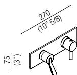
**Parte esterna per comando termostatico ad incasso con regolazione di flusso a tre uscite (ad esaurimento)**
