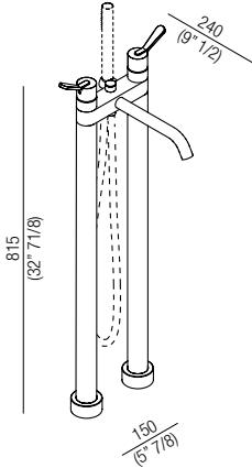
**Parte esterna per gruppo vasca, a doppio comando con deviatore e presa d'acqua per doccetta, predisposto per fissaggio a pavimento (ad esaurimento)**
