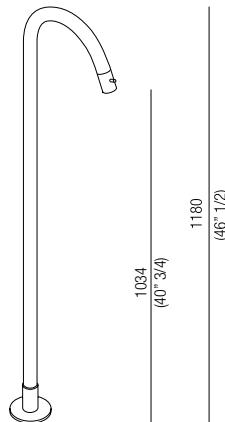
**Bocca di erogazione a pavimento con regolatore di flusso. Regolazione di temperatura non gestita (per gestire la temperatura utilizzare l'articolo .EFEZ034). H cm 118**
