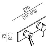
**Parte esterna per comando termostatico ad incasso con regolazione di flusso a tre uscite**
