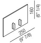
**Placca comando di risciacquo per cassetta ad incasso, con due differenti quantità di risciacquo, in acciaio inox. Completa di supporto e kit di fissaggio, si utilizza con cassette Geberitad incasso, Combifix e Duofix modelli Sigma 8 e Sigma 12**
